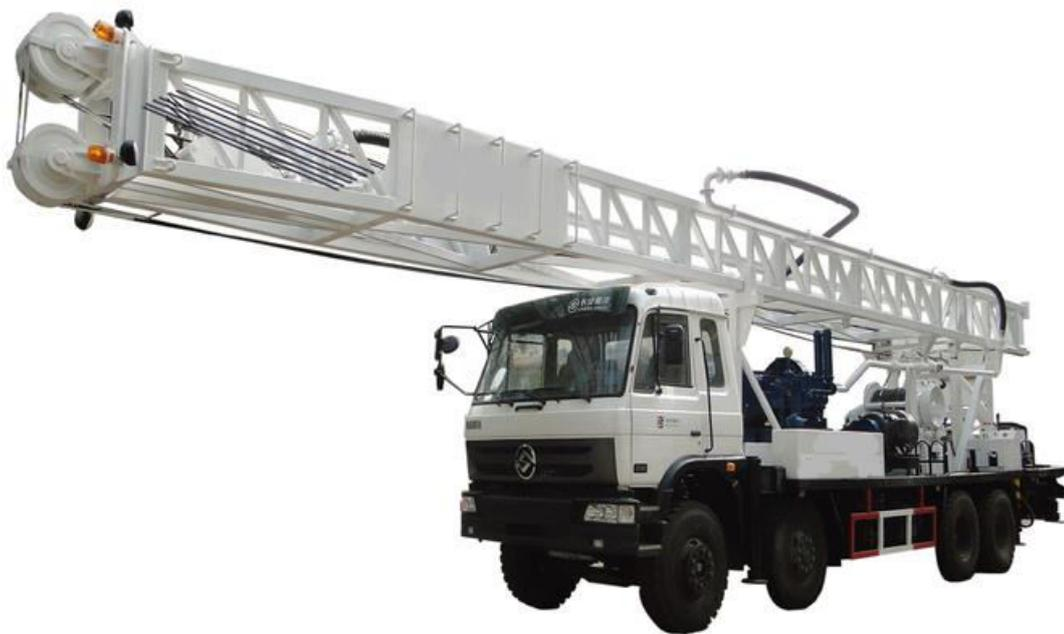
L'appareil de forage AF-SC500 est conçu pour être efficace dans des conditions géologiques difficiles à forer, et des conditions climatiques aussi dures. Elle possède la capacité de se déplacer librement par son camion intégré. Le concept économique de l'AF-SC500 lui accree un avantage par rapport à ces performances techniques, le choix de ce modèle a un retour d'investissement aussi rapide et rentable.
